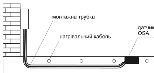
Рисунок 2. Монтажу датчика опадів OSA при підігріві ґрунту
